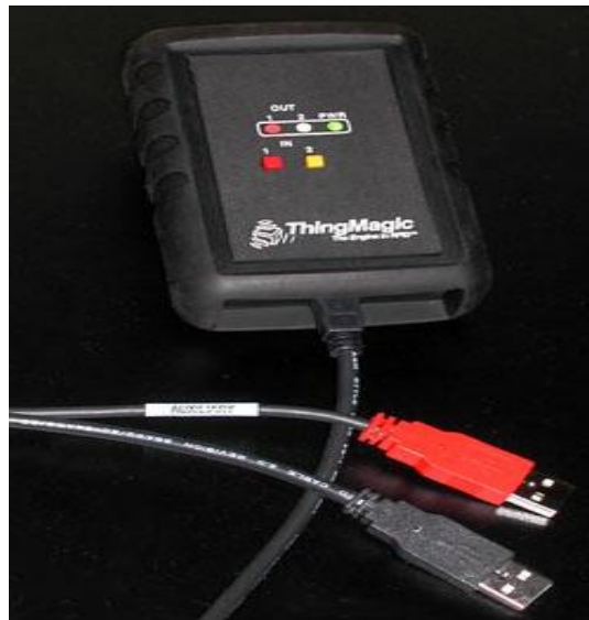
Εικόνα 4 Ο USB RFID αναγνώστης της ThingMagic
